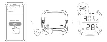
在eWeLink App Zigbee网关主界面,点击"添加"子设备,然后长按设备按钮5秒直至设备 Zigbee信号图标 (\*\*) 呈闪烁状态,此时设备进入Zigbee设备配对状态,等待添加。
